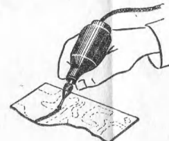
Рис. 13. Механический способ выполнения печатного монтажа
